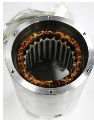
図4 製作したモータ試作機（内部）
