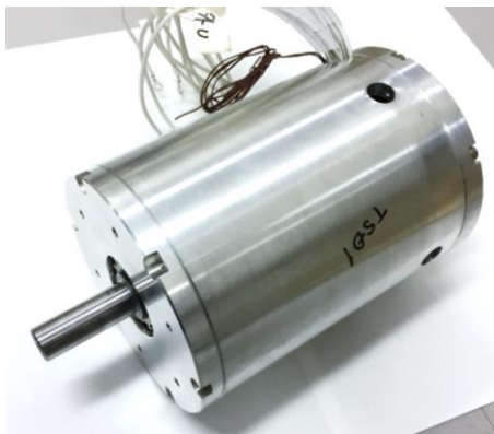
図3 製作したモータ試作機（外見）
